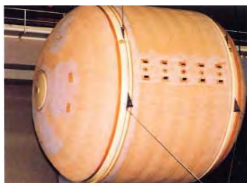
図 3-5 Boeing 社向け DELTAIV ロケット用 2 段液体水素タンク
